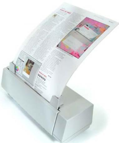
A4 幅面单面彩色馈纸式文档扫描仪。体积小，直通式的送纸机构，极短的送纸通道，ADF 可一次放置 25 页，非常适合票据扫描。USB1.1 接口，方便即插即用。ADF 扫描 (A4@200dpi, 黑白模式) 速度每分钟 10 页。AV120 具有较高的性价比，可满足用户票据和文档数字化工作的需求。
